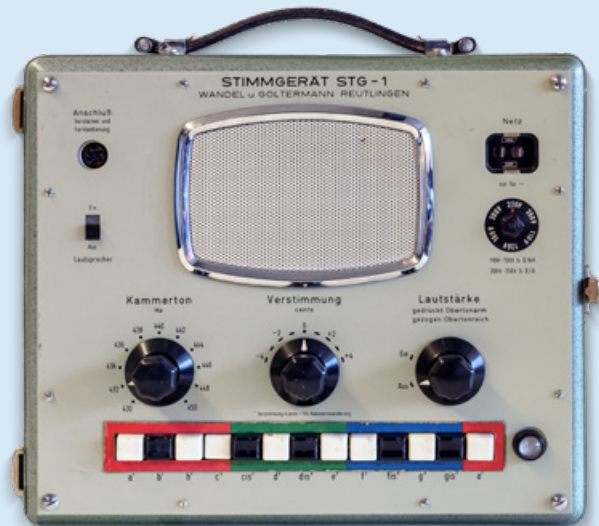
Elektronisches Stimmgerät STG-1 zur akustischen und mit Zusatzgerät auch optischen Stimmung (W&G, 1960)
